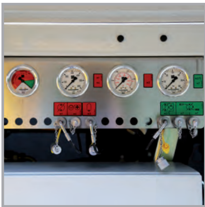
Миниатюрная панель манометров и гидроточек: все данные системы в одном месте
