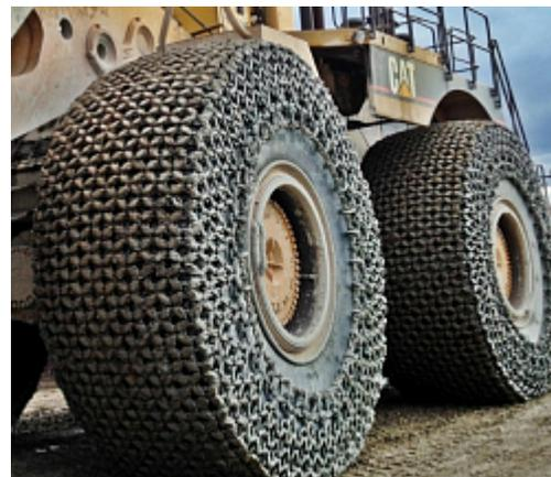
Наш производитель имеет собственное производство соединительных звеньев, выполняемое не методом горячей формовки, а исключительно методомковки в кузнечном цехе оборудованном 600, 800 и 1000-тонными гидро-пневматическими кузнечными молотами.
